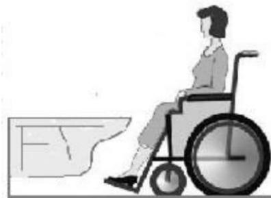
В американских стандартах указываются габариты кабины для инвалидов на кресле-коляске 1,42x1,53 м. В этой кабине установлен навесной унитаз, что расширяет зону перемещения на уровне подножки кресла-коляски.
