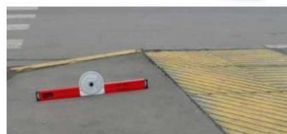
Проще всего измерить уклон съезда угломером (уклономером, клиномером).
