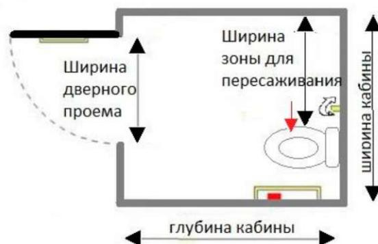
При неправильном размещении сантехнических приборов в кабине или при установке со стороны пересаживания стационарного поручня следует указать в Анкете обследования, что зона пересаживания отсутствует и кабина не доступна или частично доступна для инвалида на кресле-коляске.
