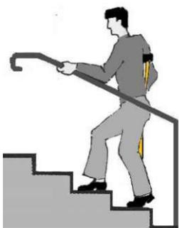
Поручни должны выступать за пределы марша. Это облегчает инвалидам-опорникам подъем на последнюю ступень или безопасный спуск с лестницы на горизонтальную поверхность, т.к. перед началом подъема на очередную ступеньку или при спуске рука всегда ставится перед корпусом человека.
