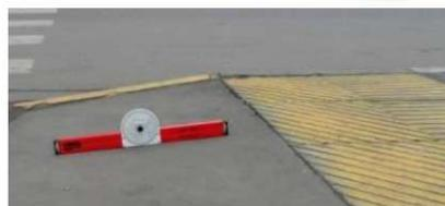
Проще всего измерить уклон съезда угломером (уклономером, клинометром).
