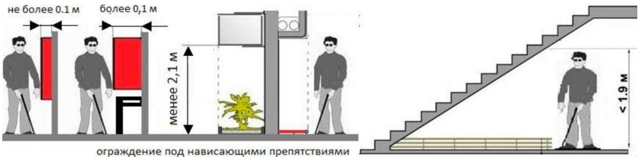
При наличии неогороженного навесного оборудования необходимо зафиксировать в Анкете обследования величину его выступа в зону движения от стены или внешнего края ограждения.
